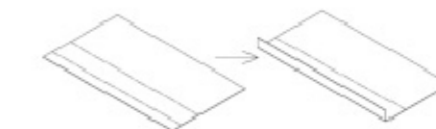
Figuur 4- in de juiste stand vouwen van de lijmplaten
